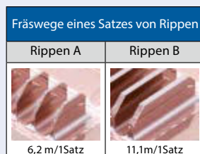
Block aus dem die Rippen gefräst werden
