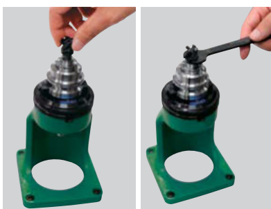
4. Fräskopf befestigen Nach dem Einschrauben von Hand mit dem PXM Spanschlüssel festziehen.
