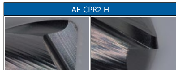
Schneidenverschleiß nach dem Schlichten
